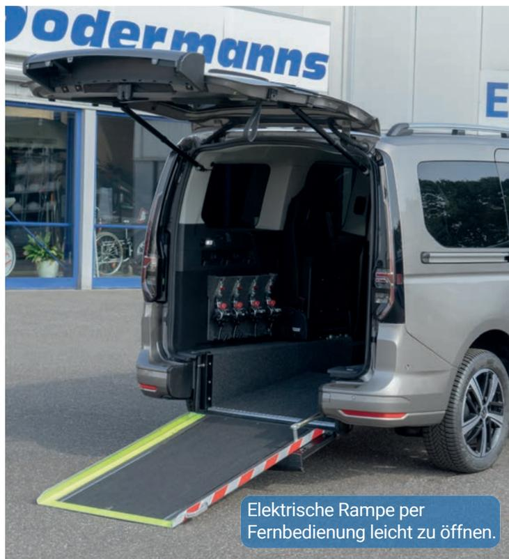
Elektrische Rampe per Fernbedienung leicht zu öffnen.
